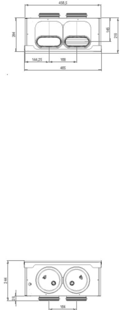
**Montaje en pared y techo:** conexiones exteriores en la parte inferior
