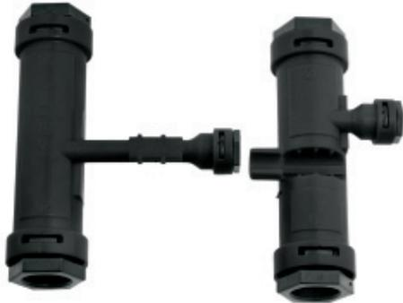
Conexión de rápida fijación para tubo multicapa de Ø20 x 2 mm y tubo PE-Xa Ø 8 x 1. Utilice dos abrazaderas de conexión nº 02000119 para unir las conexiones
